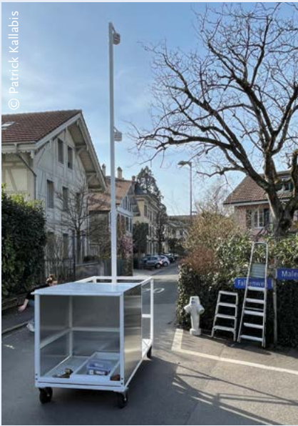
ABBILDUNG 1: Mobiler Stadtklima-Messturm mit Sensoren auf unterschiedlichen Messhöhen, konstruiert und gebaut von Patrick Kallabis, wissenschaftlicher Mitarbeiter am Geographischen Institut der Uni Bern.
