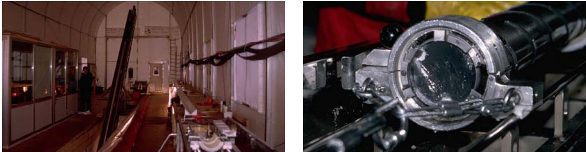
Abbildung 1.4: Bohrzelt mit Bohrturm in Dome C; Bohrkopf mit Eisbohrkern (Foto rechts J. Flückiger).
