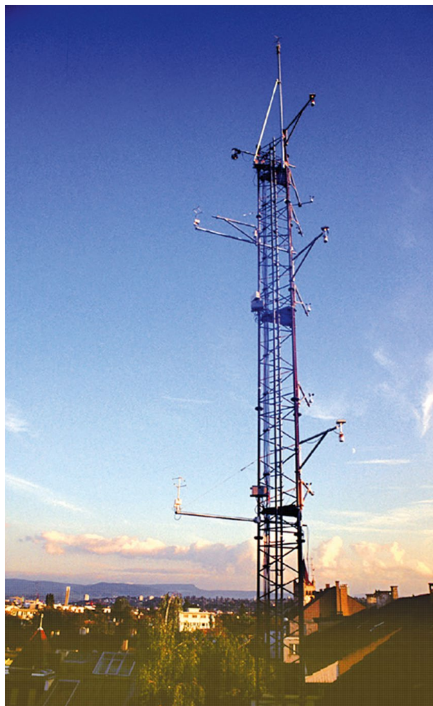
Abbildung 12-8: Messturm auf dem Dach des ehemaligen Meteorologischen Instituts der Universität Basel, ausgestattet mit einer Vielzahl meteorologischer Messgeräte auf unterschiedlichen Höhen zur Untersuchung der vertikalen Turbulenzprozesse in der Stadthindernisschicht. Die Daten fanden unter anderem im BUBBLE-Projekt Anwendung (ROTACH et al. 2005; Foto: https://www.mcr.unibas.ch/dolueg2/projects/campaigns/BUBBLE/textpages/ov_frameset.en.htm ).
