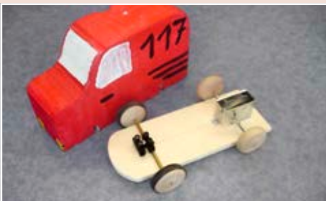
Prototyp eines Fahrzeugs mit Federwerktriebemotor Fahrzeugunterbau und gestaltete Karosserie
